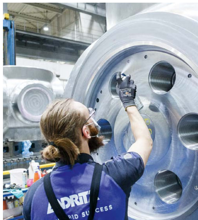
Inspeção de fendas nas superfícies vedantes do rotor de válvulas
