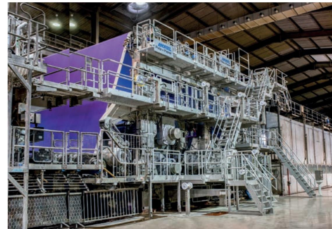
▲ 安德里茨在Iggesund的BM2上安装了一套全新的压榨部，其包括一个带有大直径辊的宽压区大辊压榨，一个高效节能的PrimePress X的第二道靴压，和一道光泽压榨。供货同时也包括了安德里茨最先进的从压榨部到干燥部的PrimeFeeder真空无绳引纸系统。
