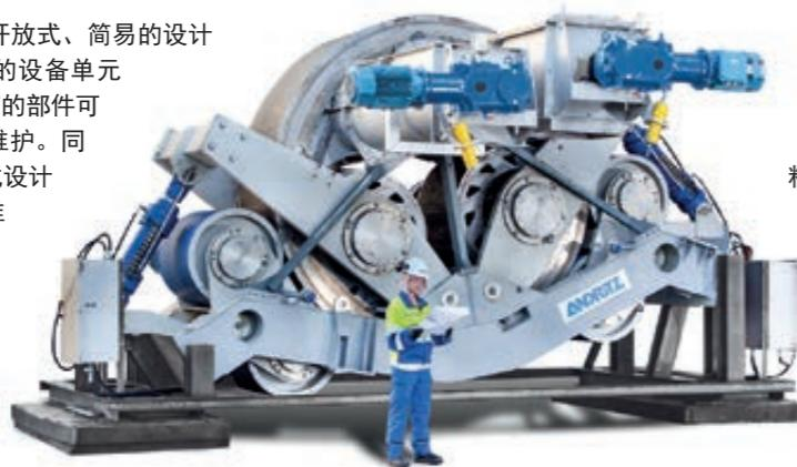
挤压后的物料达到比较高的干度。传统的挤压脱水机通常情况下可以使年平均物料干度达到40%，在正常运行情况下，HQ-Press树皮挤压脱水机可以使物料的年平均干度达45%。设备单元的先进控制可以在各种操作条件下实现产出最大化。
