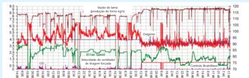
Temperatura da extremidade de alimentação 1006 A, manual X BrainWave, na fábrica de Ružomberok da Mondi (março- abril de 2009) ▼
